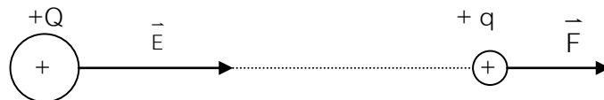
รูป 5. ทิศของแรงที่กระทำต่อประจุ +q มีทิศเดียวกับทิศของสนามไฟฟ้า
