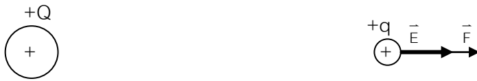
รูป 2 ทิศของสนามไฟฟ้า \vec{E} ของประจุ +Q กับทิศของแรง \vec{F} กระทำต่อประจุทดสอบ +q
